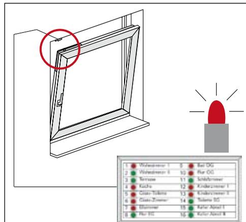
Durch die Koppelung an den Beschlag ist die Alarmanlage erst dann aktiviert, wenn der Beschlag verriegelt und nicht nur angelehnt ist.
